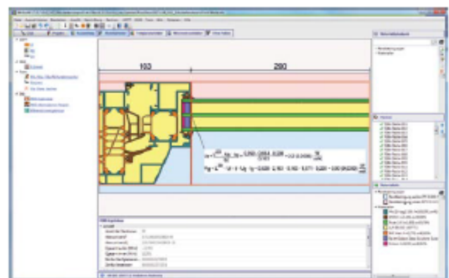
Die überarbeitete Software ermöglicht eine getrennte Auswertung von Strahlungswärmeübertragung und luftgebundener Wärmeübertragung
